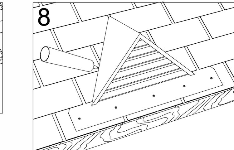
8 Fixer l'épaulement du bas à l'aide vis à toiture galvanisée avec rondelle de caoutchouc. Appliquer un cordon de scellant sur tout le périmètre afin de bien imperméabiliser.
