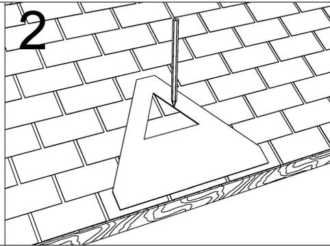
2 Placer le gabarit sur la toiture en vous assurant d'être entre les poutres. Tracer une ligne sur la toiture autour du gabarit et à l'intérieur de l'ouverture à l'aide d'une craie.
