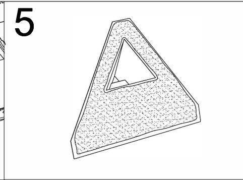
5 Appliquer une généreuse couche de bitume sur la surface du dessous du solin, fixer à la toiture à l'aide de vis. (vis fournies par le contracteur)
