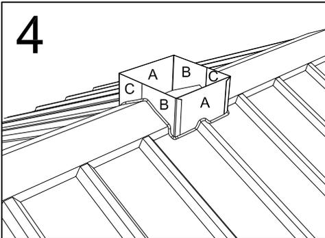
4 Enlever quelques vis de la toiture afin de lever et glisser les composantes (A-A, B-B and C-C) du contre-solin entre le métal et le bois. Sceller tous les joints avec du mastic à calfeutré ou un cordon de bitume.
