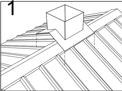
1 Placer le solin au-dessus du faîte de la toiture en métal à l'endroit désiré et tracer la toiture par l'intérieur du solin.
