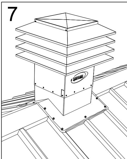
7 Installer la tête du ventilateur sur le solin de faîte, mettre au niveau et fixer avec les vis fournies, dans toutes les perforations. (Modèle 301 démontré)
