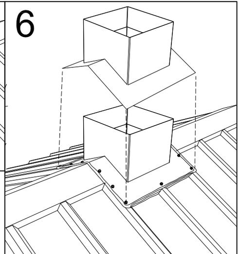
6 Installer le solin au dessus du contre-solin et fixer à la toiture (attaches fournies par le contracteur). Appliquer un cordon de bitume de bonne qualité tout au tour du solin ainsi que dans toutes les ouvertures entre la toiture de métal et le solin.
