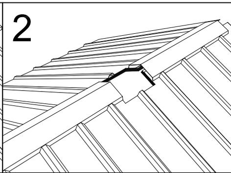
2 Découper une ouverture dans la toiture en suivant le tracé.
